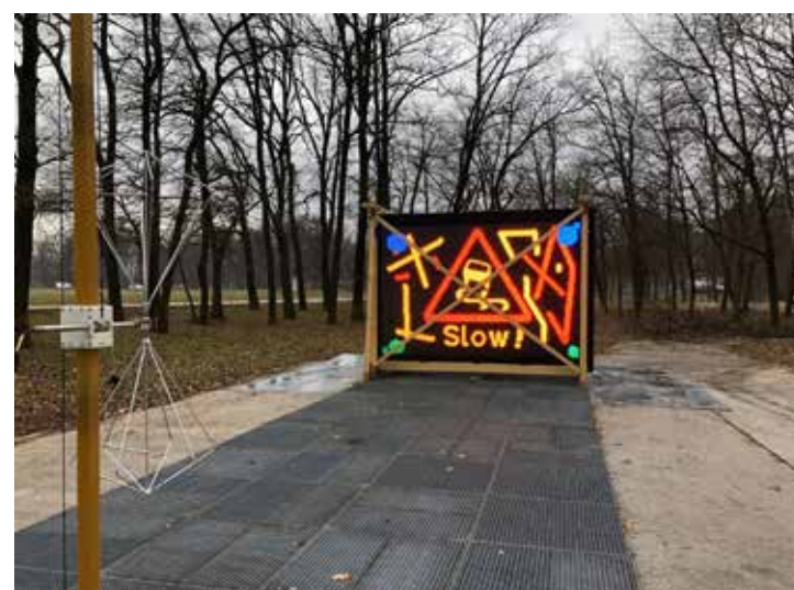
Preskušanje elektromagnetne združljivosti znaka spremenljivih vsebin na poligonu OATS.
