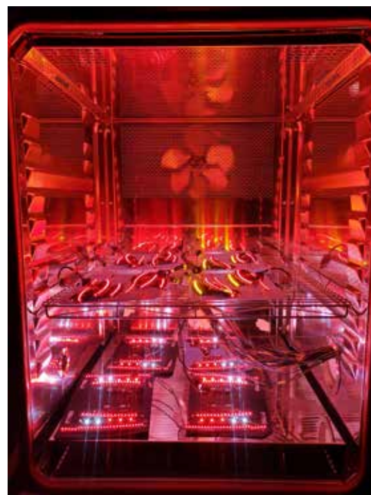
Tiskana vezja avtomobilskega žarometra v klimatski komori pred izvedbo kondenzacijskega testa.
